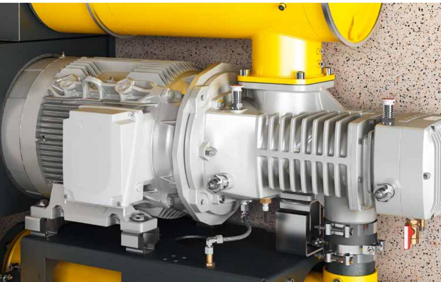
U vijčanim puhalima serija CBS, DBS i EBS prijenos pogonske snage s motora prema bloku puhalja odvija se putem integriranog zupčaničkog prijenosa. To se rješenje ustalilo kao optimalno za brojeve okretaja koji nastaju u ovoj klasi snage i veličine po pitanju stupnja učinkovitosti, pouzdanosti i dugovječnosti. Na seriji HBS prijenos snage je izravan i bez gubitaka, a odvija se putem spojke. Ti koncepti rezultat su kontinuiranih istraživanja u centrima tvrtke KAESER za istraživanje i razvoj.
